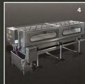
Cooling tunnel Kühltunnel Tunnel di raffreddamento
