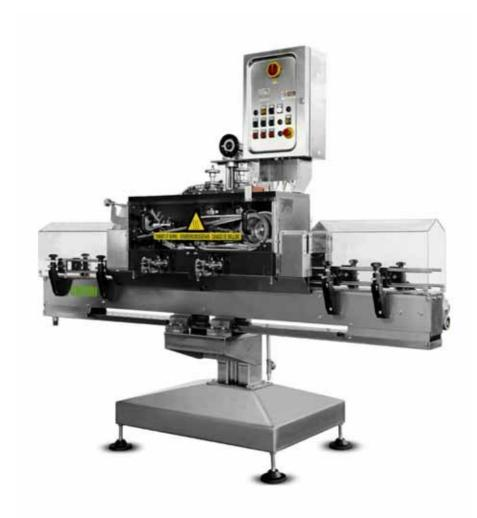
本体フレームは衛生的なステンレス製。 ヘッド部は防錆 加工アルミを使用、容易な清掃、メンテナンス。
