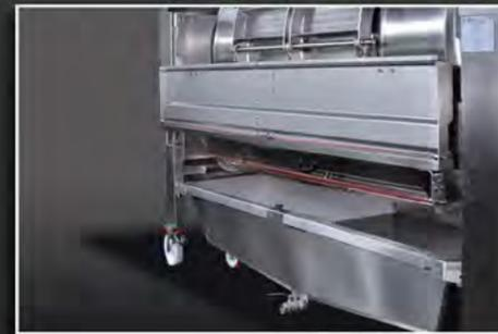
上部ジュース飛散防止カバーが開きます。これによりタンク内部の点検や、清掃が無理なく作業出来ます。上下ともにオープン時停止安全装置付。
