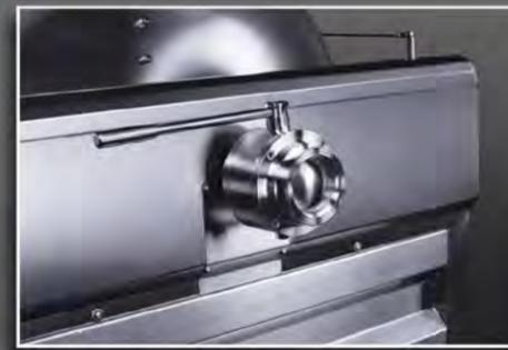
センター充填機構はタンクを回転させながら素早く効率の良い充填が可能です。充填と同時にジュースも排出されるので、ドア充填よりも多くの量を充填することが可能です。口径は DN60-80-10-120のサイズがあります。手動ボールバルブ又はエア式ゴムバルブが選択出来ます。
