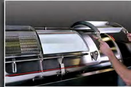
大口径スライドドアは素早い充填とカス排出が可能です。スムーズに開閉できるように設計されたドアはヒンジ構造で開くようになっており、ドア部に挟まり込む果肉の清掃が簡単に行なえます。
