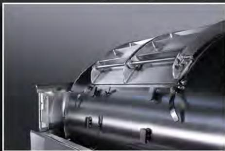
Sraml社プレス tanks のタンク形状は2種類あります。全面クローズパネルのクローズタイプ（完全密閉ではありません）タンク内部の液抽出メッシュチャンネルを通して排出します。オプションで集中排出（液出口1ヶ所）も可能
